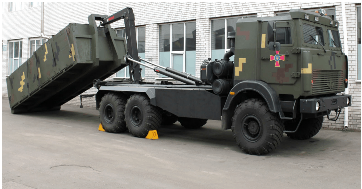
Рис. 3.10. Вантажівка МАЗ з мультиліфтом моделі ULTIMA 21S.56 CHU
