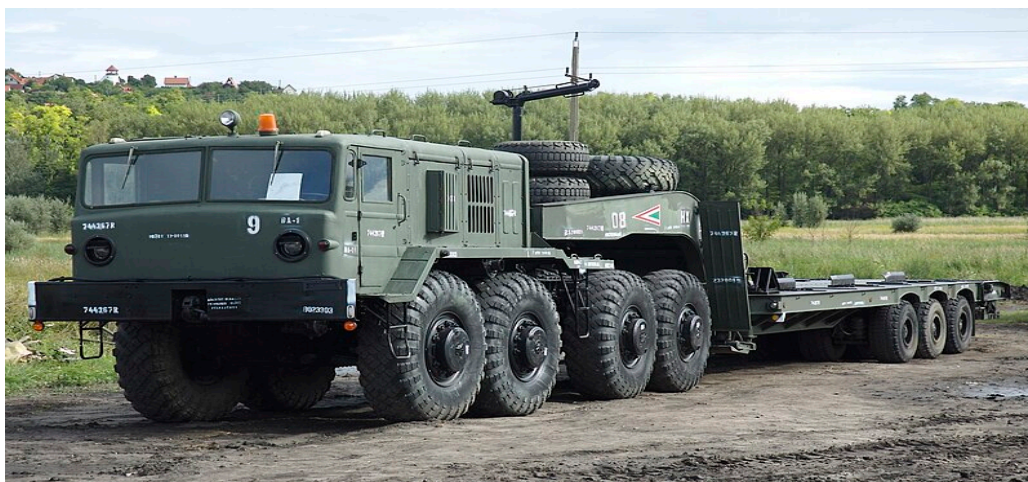
Рис. 1.27. Автомобільний тягач МАЗ-537: а – загальний вигляд; б – з напівпричепом
