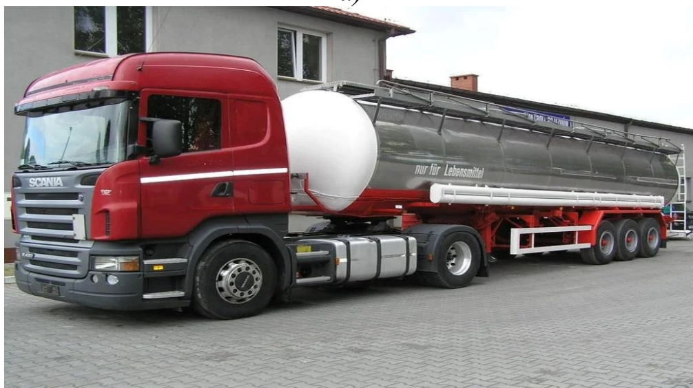
Рис. 1.21. Вантажний автомобіль у складі сидельного тягача та автоцистерни-напівпричепа із загальною кількістю осей:
