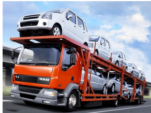
Рис. 1.25. Автомобільні транспортні засоби за типом кузова: а – рефрижератор; б – самоскид; в – тентований; г – напівпричіп цистерна; д – бортовий; е – перевезення легкових автомобілів
