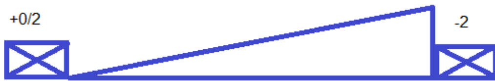
Рис. 4.19. Нанесення на сітку операції завантаження за умови, якщо розвантаження не передбачалося
