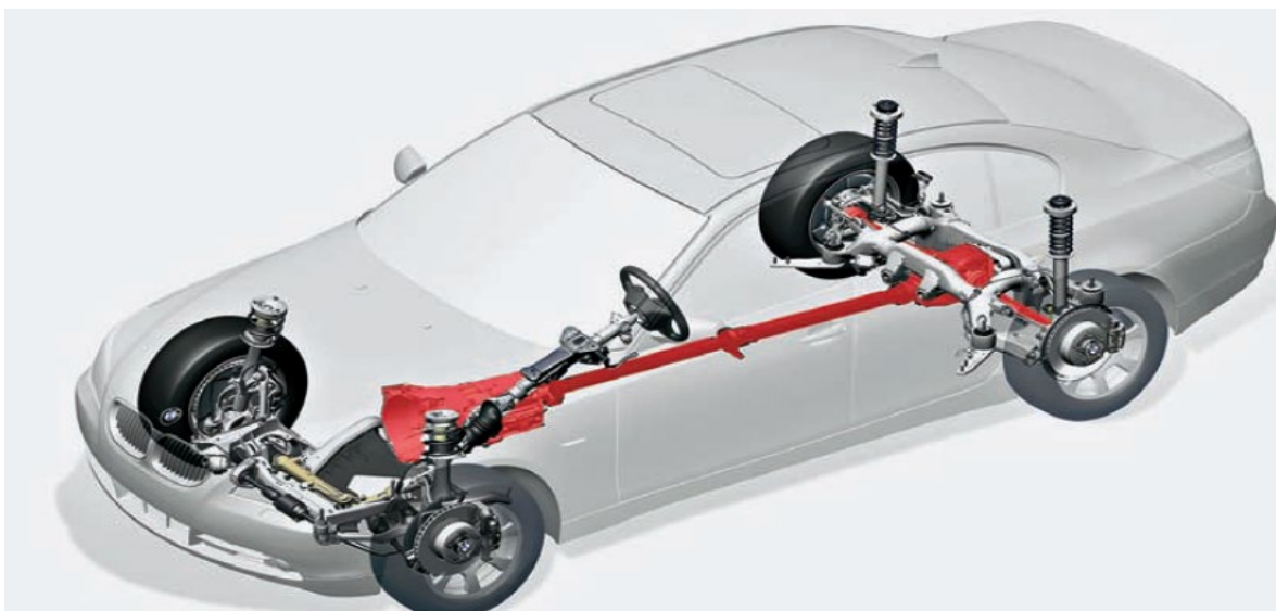
Рис. 1.3. Механічна трансмісія класичного автомобіля
