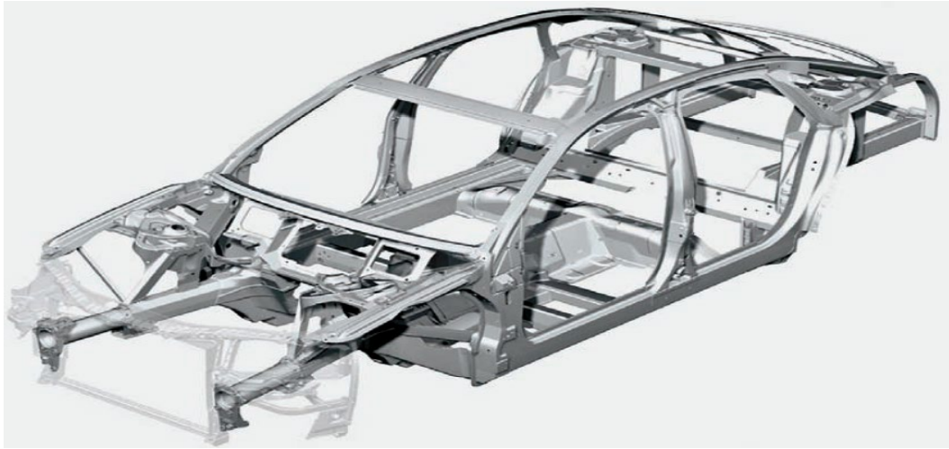
Рис. 1.5. Силова схема несучого кузова легкового автомобіля
