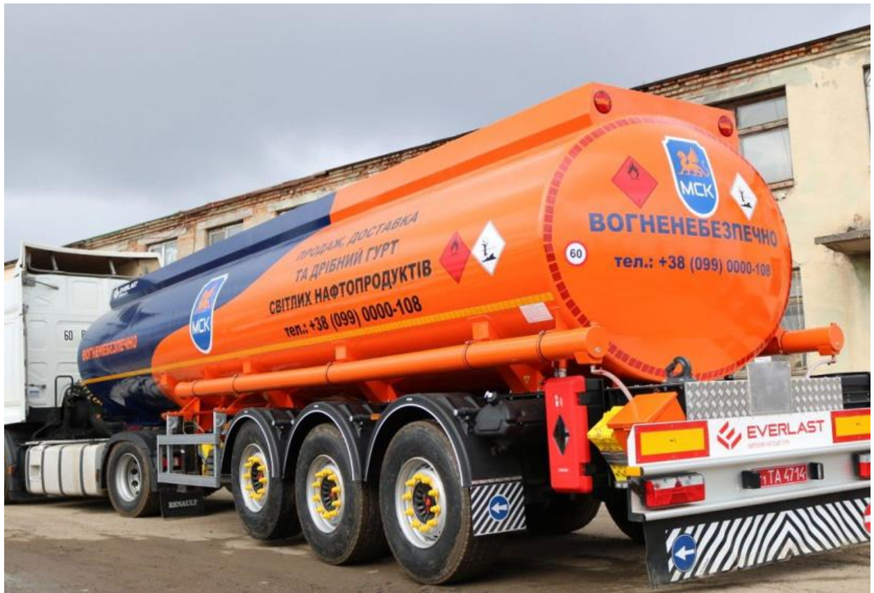
Рисунок 1.7 – Зовнішній вигляд маркування автомобіля-цистерни для перевезення небезпечних вантажів
