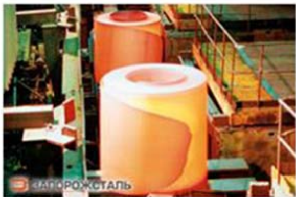
Рисунок 1 – Готові рулони листового прокату на виході із стану
