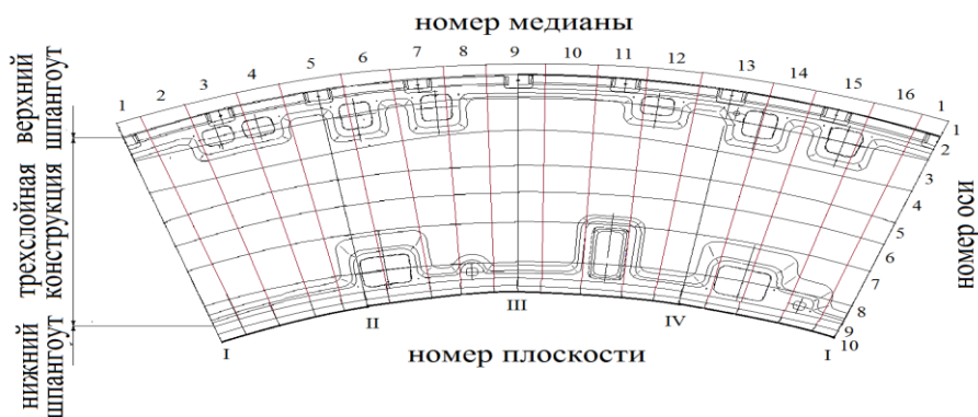
Рис. 1. Схема разбиения развертки внешней поверхности корпуса (номера осей: 1, 9 – верхний и нижний шпангоуты; 2, 8 – район перехода трехслойной конструкции к соответственно верхнему и нижнему шпангоутам; 3, 4 – район верхних и нижних окон; 4, 6 – выше и ниже средней линии; 5 – средняя линия)
