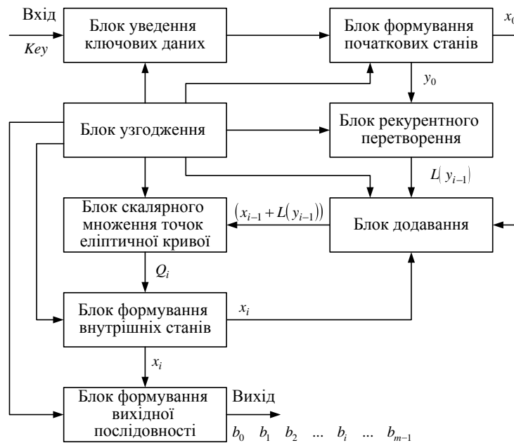
Рис. 1. Структурна схема пристрою формування псевдовипадкових послідовностей максимального періоду з використанням перетворень у групі точок еліптичної кривої
