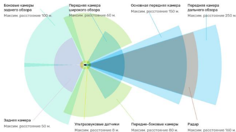
Рис. 1. Схема розташування датчиків автопілота Tesla
