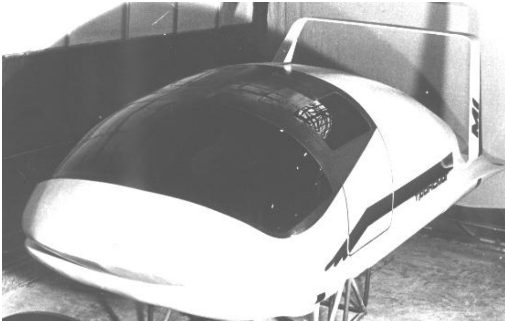
Рис. 5. Дослідний апарат на надпровідних магнітах
