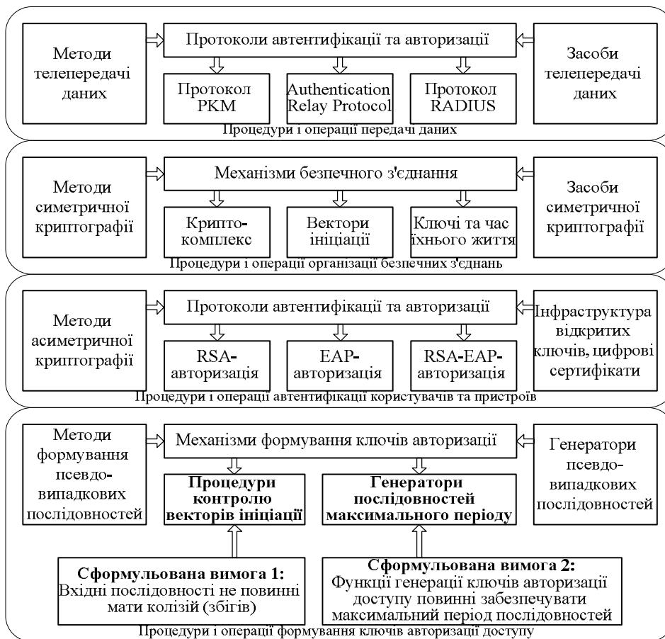
Рис. 1. Структурна схема удосконаленого методу авторизації та автентифікації безпроводового доступу для підвищення безпеки телекомунікаційних систем та мереж
