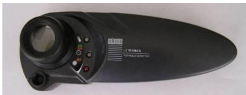
Ультрамаг-АЗ-2 Лупа 10(25) - кратна; ультрафіолетовий випромінювач 365/264 нм.
