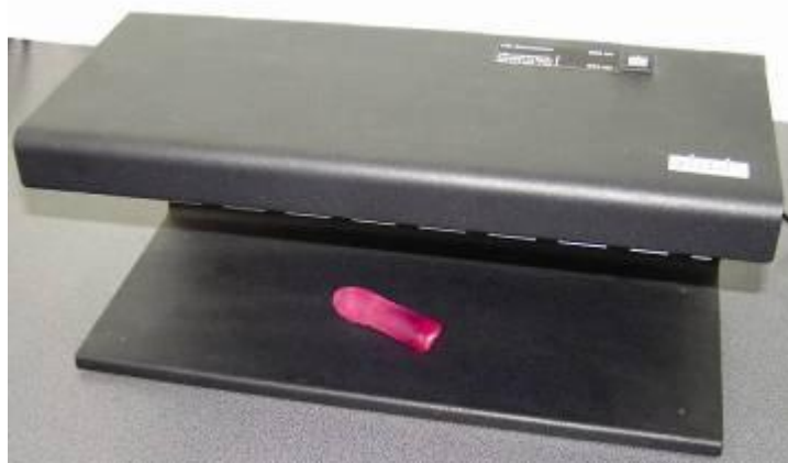
Ультрамаг КЗ-22 Зручність при дослідженні коштовного каменя, потужний ультрафіолет (Philips) 2/8В -365/264 нм; спеціальний піддон;
