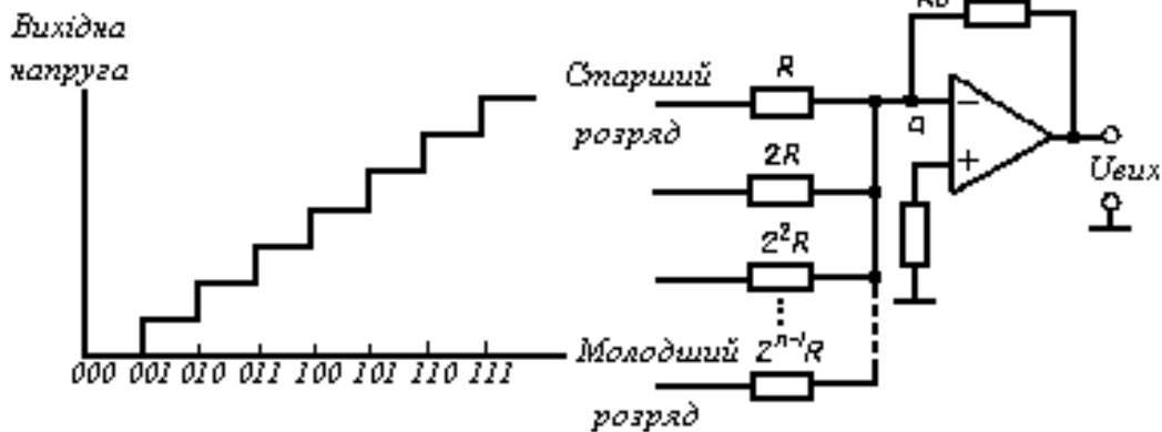
Рис. 7.1. Залежність вихідної напруги ЦАП від цифрового сигналу на вході
