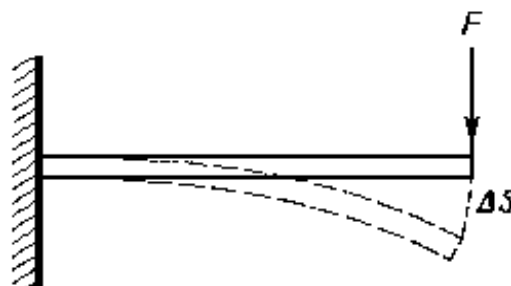
Рис. 3.9. Відхилення консольної штанги під дією сили. Принцип дії \Delta S – лінійне відхилення в одиницях F – сила.
