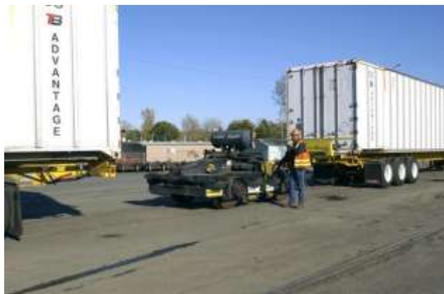
Рис. 5. Формування складу з бімодальних платформ RailRunner
