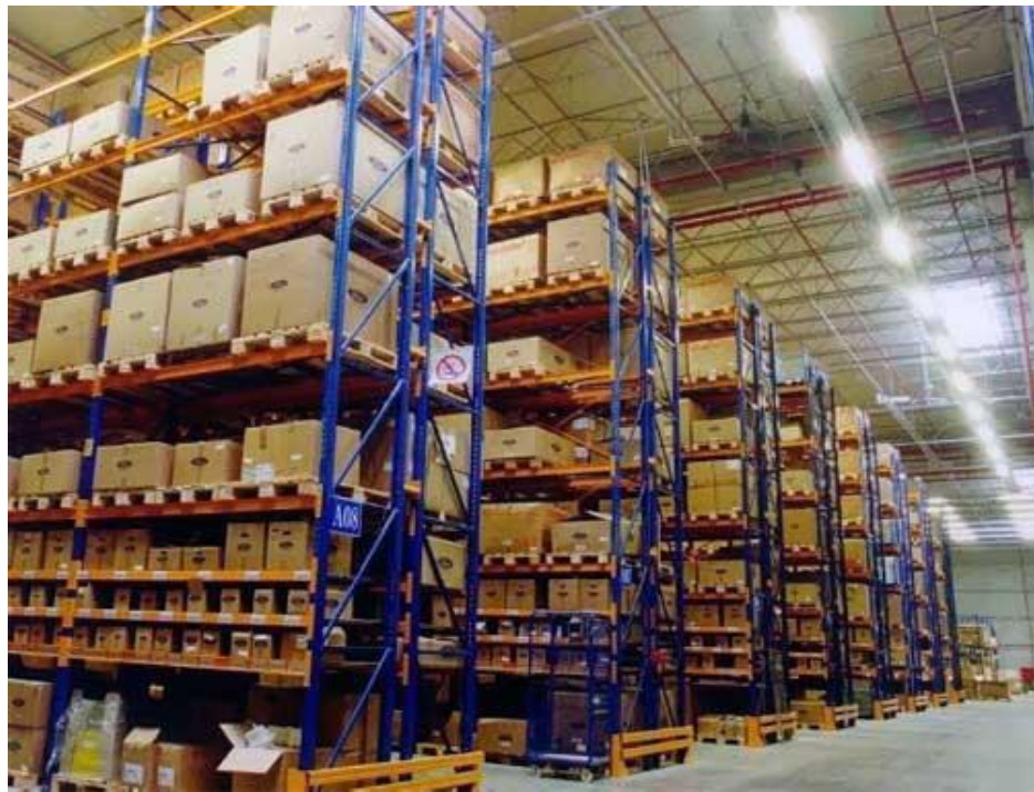
Рисунок 2.10 – Приклад стелажної укладки вантажів [23]
