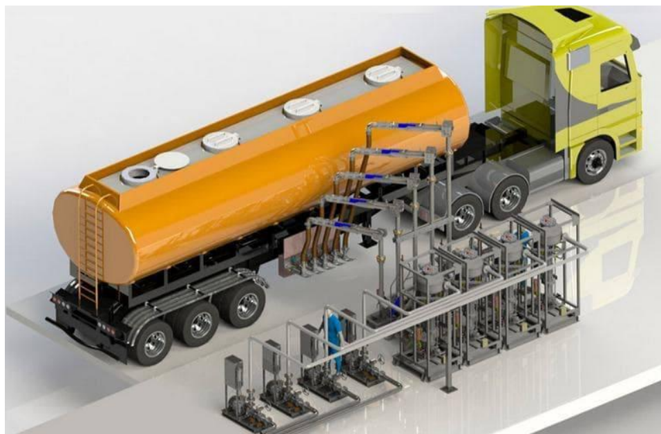
Рисунок 2.8 – Процес наповнення цистерни нафтопродуктом за допомогою установки АСВН-80 [24]
