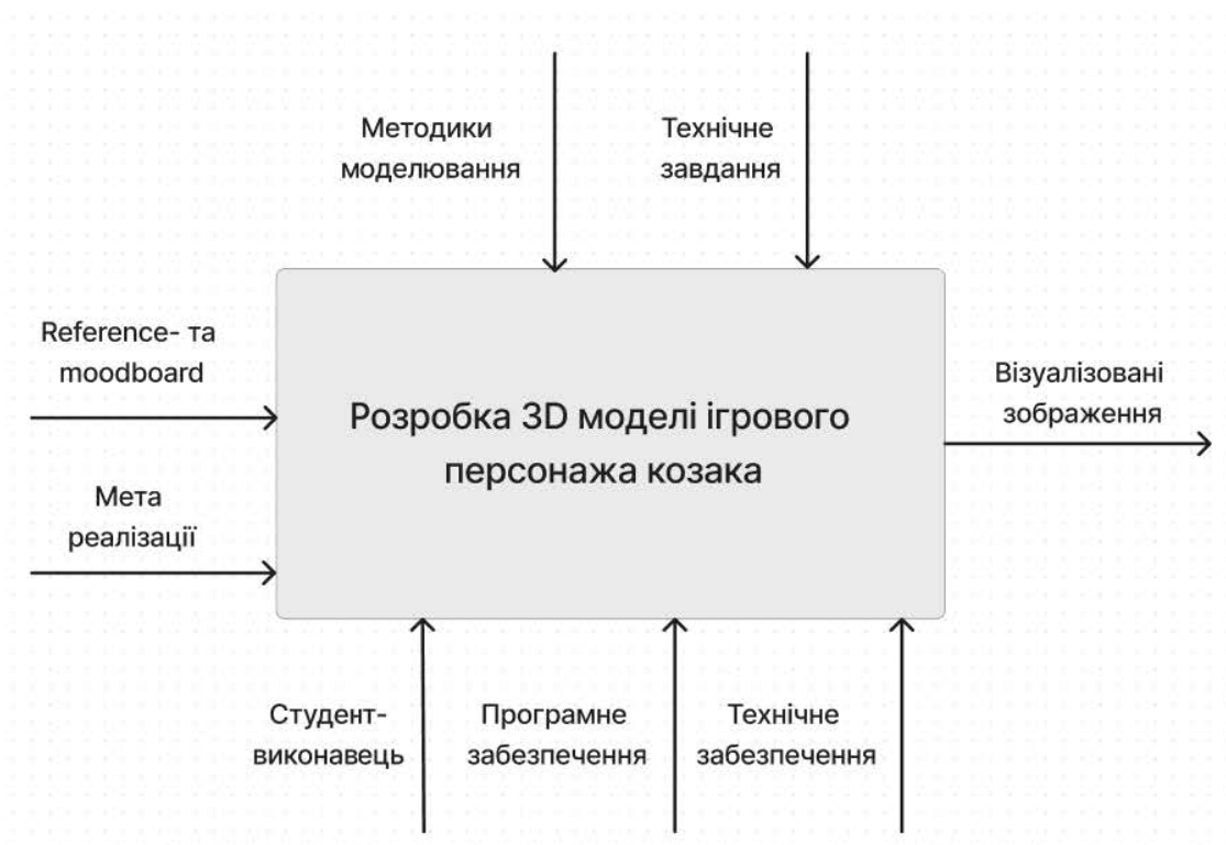
Рисунок 2.7 – Діаграма нульового рівня (контекстна) моделі IDEF0
