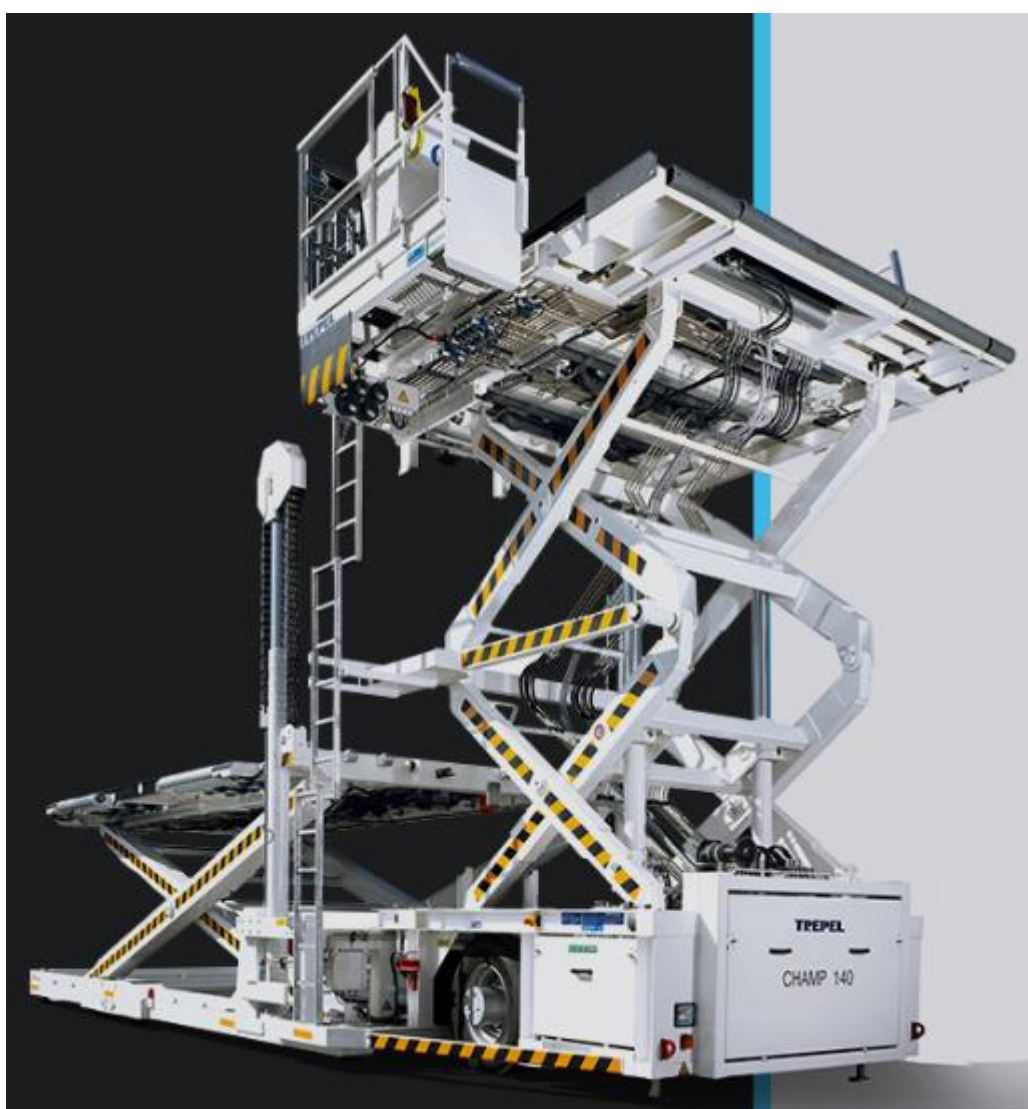
Рисунок 4.1 – Контейнерний навантажувач Trepel CHAMP 140 [34]
