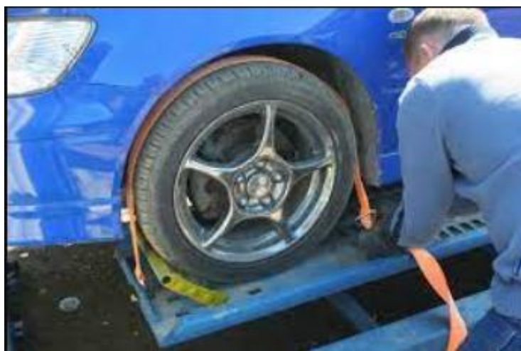
Рисунок 3.7 – Фіксація транспортного засобу в контейнері [39]
