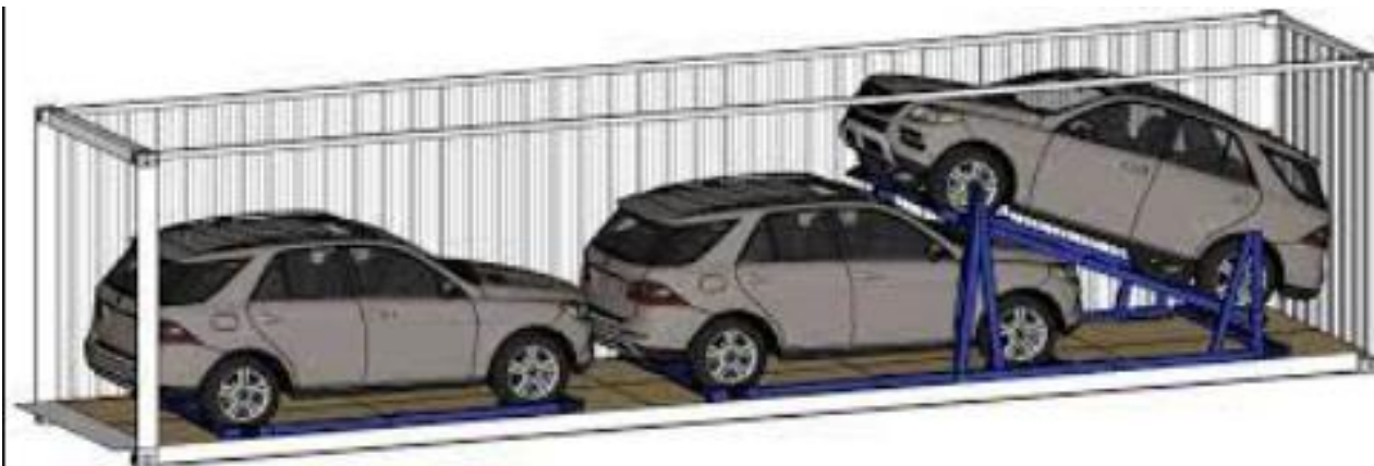
Рисунок 3.8 – Розміщення вантажу в контейнері [42]
