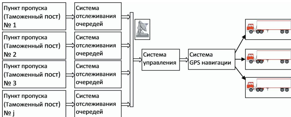
Рис. 1. Схема передачи информации для системы GPS навигации
